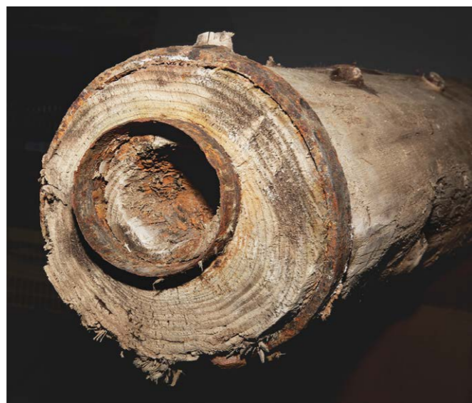
► Fig. 24 : extrémité d'un tuyau de bois trouvé à Saverne (XVIII e ou première moitié du XIX e siècle). La virole et la frette, toutes deux en fer, sont conservées (cl. Francis Goubet).
